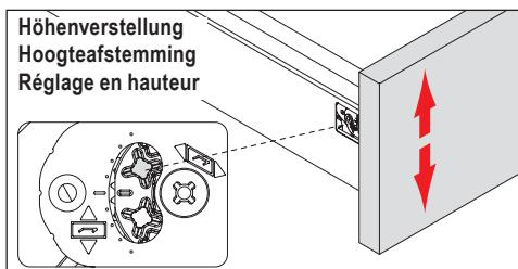
Die Frontblende kann durch Drehen der Schrauben auf beiden Seiten eingestellt werden.
