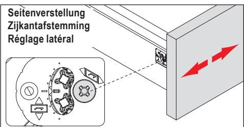
Die Frontblende kann durch Drehen der Schraube auf beiden Seiten eingestellt werden.
