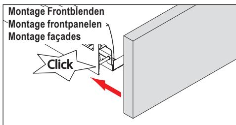
Die Frontblende an die Zarge führen. Die Blende rastet automatisch und hörbar auf beiden Seiten ein.
